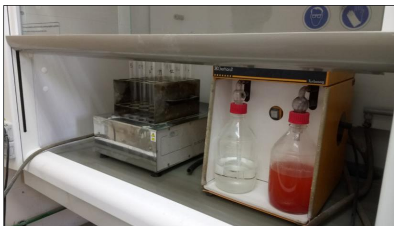
Figura 6. Matrices Kjeldahl preparados para la digestión de la materia orgánica del suelo y reducción del nitrógeno a ión amonio (izquierda). Disolución de NaOH al 20% que recoge los gases que son emitidos (derecha).
