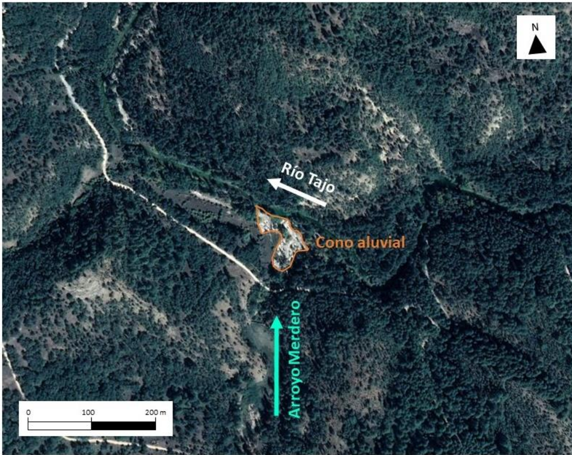
Figura 5 Cono aluvial formado por la acumulación de sedimentos procedentes de la mina Santa Engracia en la confluencia del arroyo Merdero y el río Tajo.
