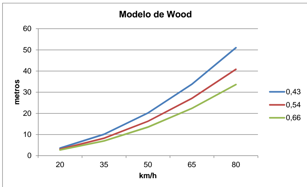
Figura núm. 5-13. Gráfico en el que se muestra la distancia de proyección en función de las velocidades de atropello para distintos valores de coeficientes de fricción con datos de peatones adultos, atropellados con vehículos cuya masa es de 985 kg utilizando el modelo de Wood.
