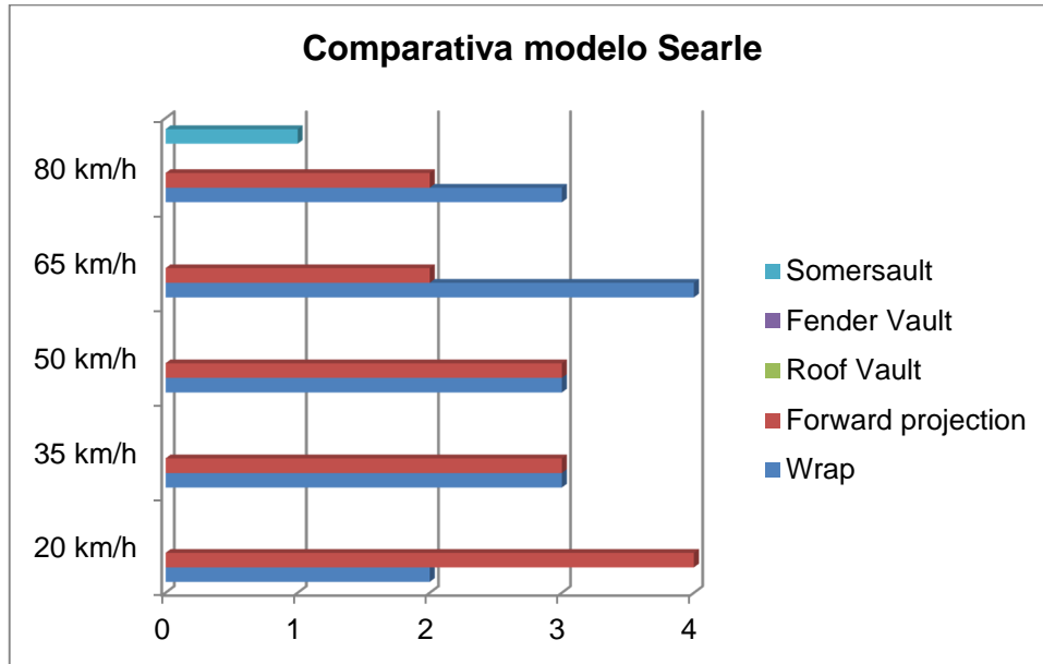
Figura núm. 7-39. Gráfico en el que se muestran los distintos tipos de trayectoria post-impacto en función de las velocidades a las que han sido producidas para peatones de 6 años utilizando \mu = 0,5 , según el modelo de Searle.
