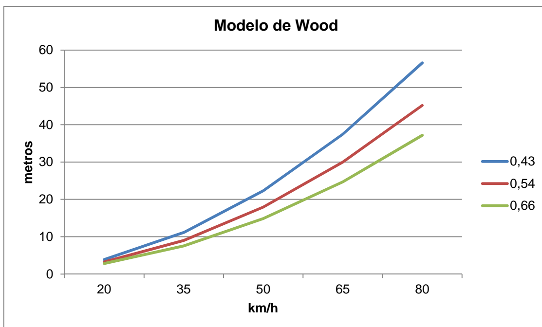
Figura núm. 5-12. Gráfico en el que se muestra la distancia de proyección en función de las velocidades de atropello para distintos valores de coeficientes de fricción con datos de peatones de 10 años, atropellados con vehículos cuya masa es de 1.775 kg utilizando el modelo de Wood.
