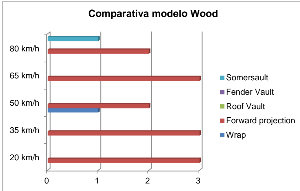
Figura núm. 7-55. Gráfico en el que se muestran los distintos tipos de trayectoria post-impacto en función de las velocidades a las que han sido producidas para peatones de 3 años y 6 meses utilizando \mu = 0,54 según el modelo de Wood.
