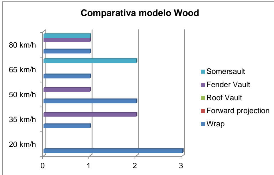
Figura núm. 7-65. Gráfico en el que se muestran los distintos tipos de trayectoria post-impacto en función de las velocidades a las que han sido producidas para peatones de 10 años, utilizando \mu = 0,43 según el modelo de Wood.
