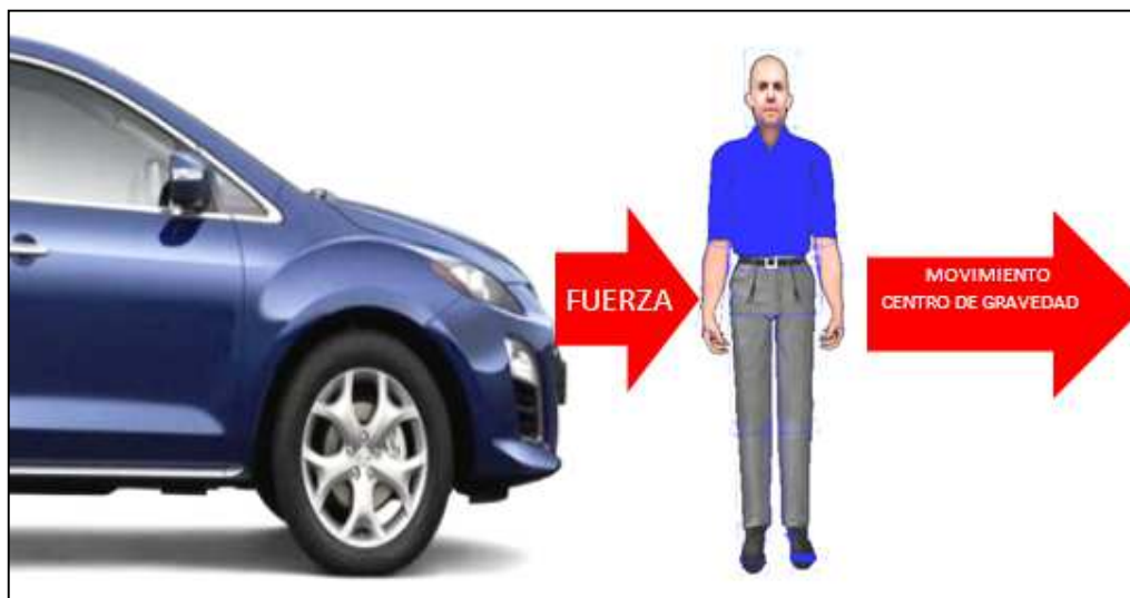
Figura núm. 3-2. Peatón atropellado situando su centro de gravedad (c.d.g) a la misma altura de la línea de fuerza del vehículo.
