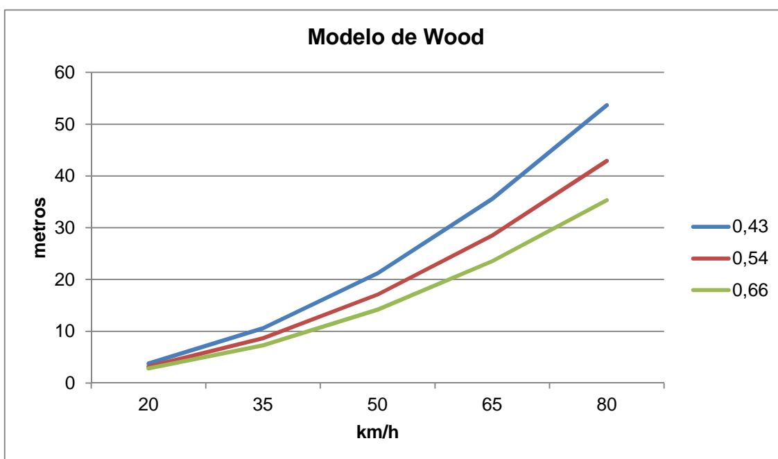
Figura núm. 5-14. Gráfico en el que se muestra la distancia de proyección en función de las velocidades de atropello para distintos valores de coeficientes de fricción con datos de peatones adultos, atropellados con vehículos cuya masa es de 1.530 kg utilizando el modelo de Wood.
