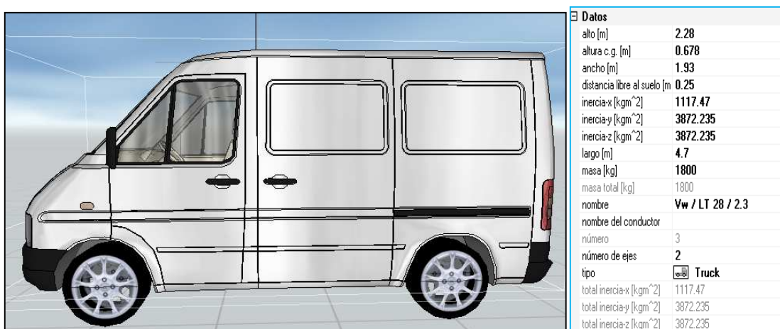
Figura núm. 6-13. Captura del programa Virtual Crash donde se observa la imagen y datos del vehículo Volkswagen LT 28 2.3.
