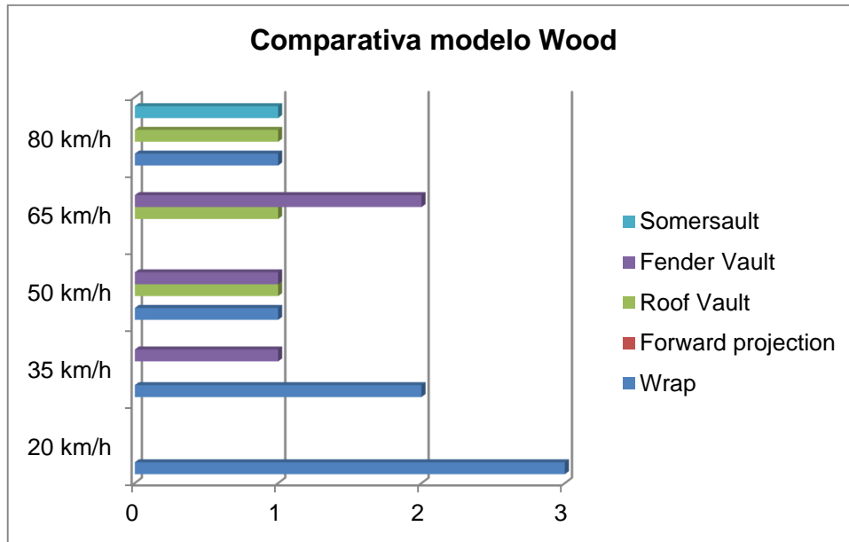
Figura núm. 7-85. Gráfico en el que se muestran los distintos tipos de trayectoria post-impacto en función de las velocidades a las que han sido producidas para peatones adultos, utilizando \mu = 0,54 según el modelo de Wood.
