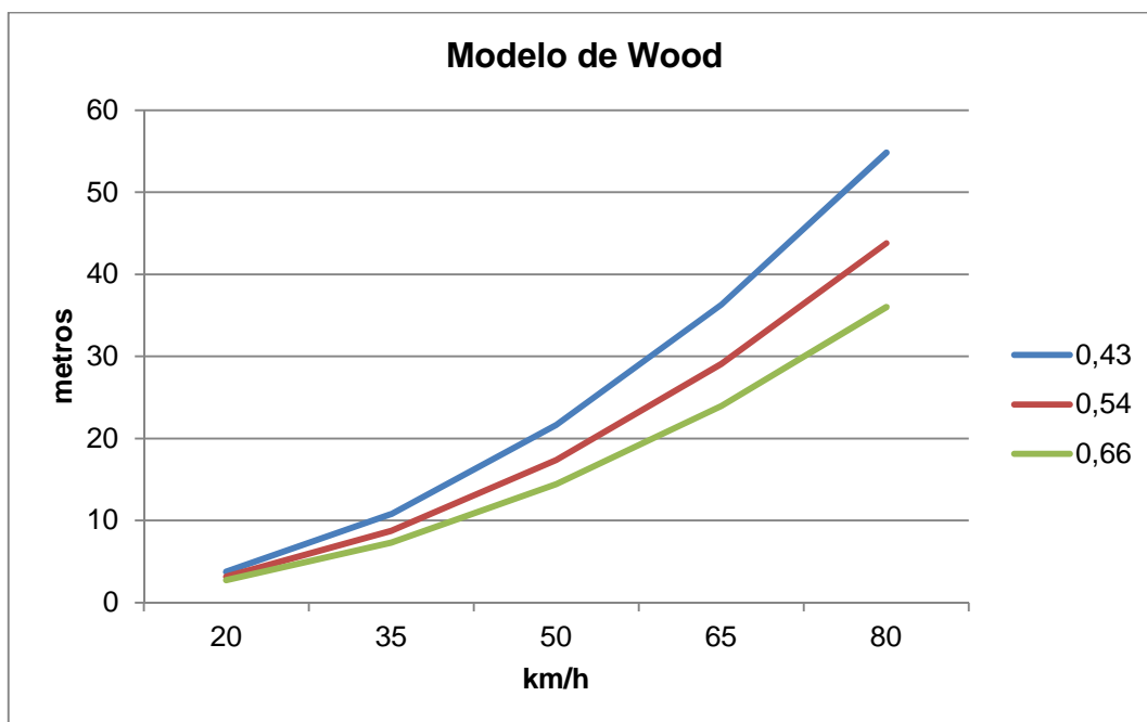
Figura núm. 5-10. Gráfico en el que se muestra la distancia de proyección en función de las velocidades de atropello para distintos valores de coeficientes de fricción con datos de peatones de 10 años, atropellados con vehículos cuya masa es de 985 kg utilizando el modelo de Wood.
