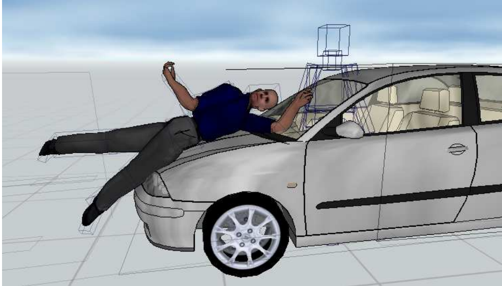
Figura núm. 6-35. Captura del programa Virtual Crash, en la que se muestra el impacto de la cabeza del multibody sobre la estructura del vehículo tras el atropello.
