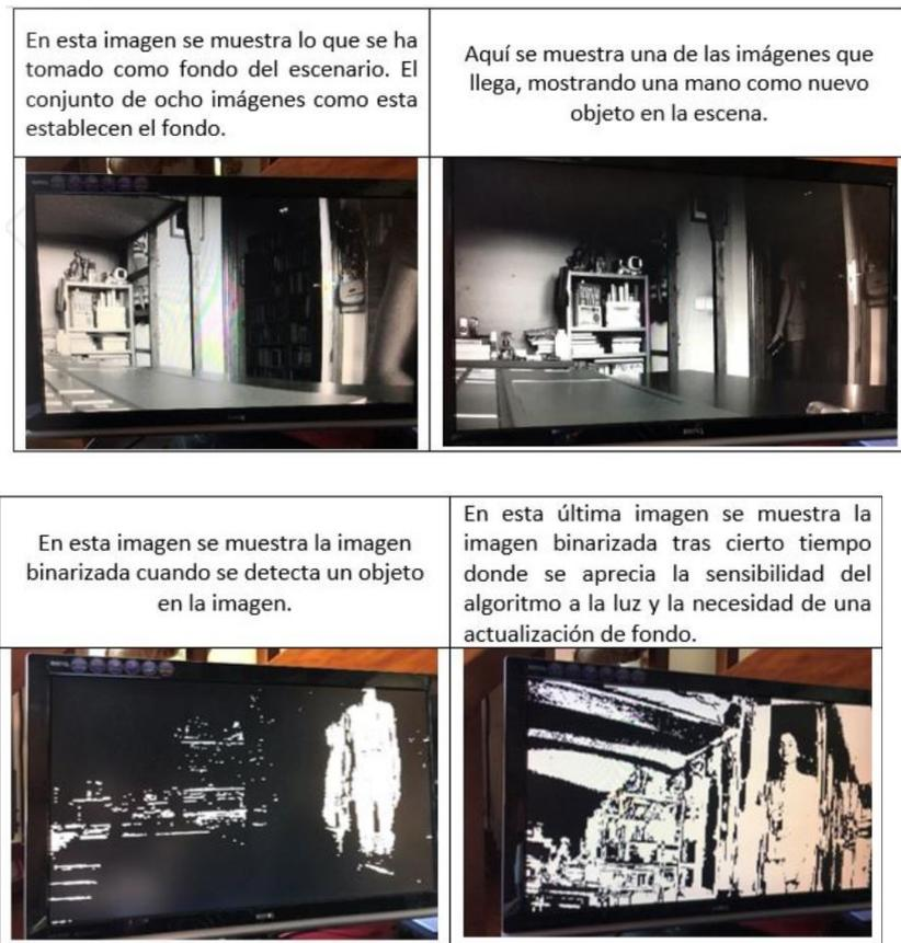
Figura 59: Segundo escenario de demostración de PCA en un sistema de tiempo real
