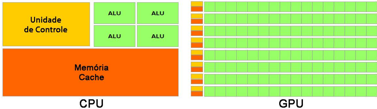
Figura 20. Estrutura das plataformas CPU e GPU.
