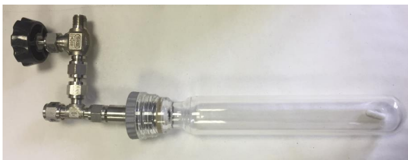
Figura 3.4.1. Reactor Fischer-Porter empleado en las reacciones de hidrogenación.
