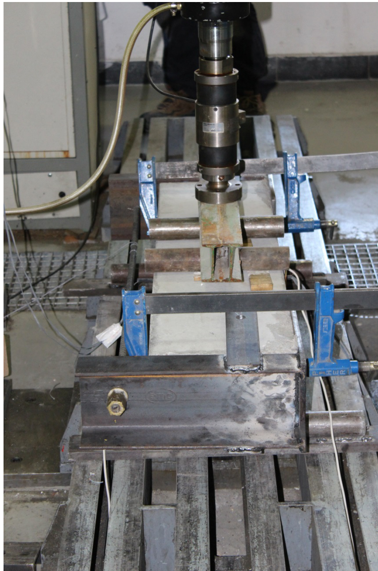
Figura 4.20. Soporte de hormigón colocado para la aplicación de la carga exterior en el plano débil de la sección transversal y el axil de tesado exterior aplicado. Autor.
