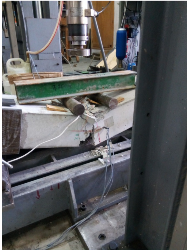
Figura 4.50. Soporte ensayado instantes después de alcanzarse su agotamiento en el ensayo 2. Autor.
