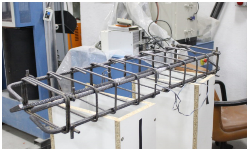
Figura 4.2. Armadura de uno de los soportes construidos previo a su hormigonado. Autor.
