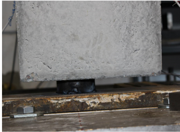
Figura 4.10. Detalle del apoyo inferior del soporte durante el ensayo 1. Autor.
