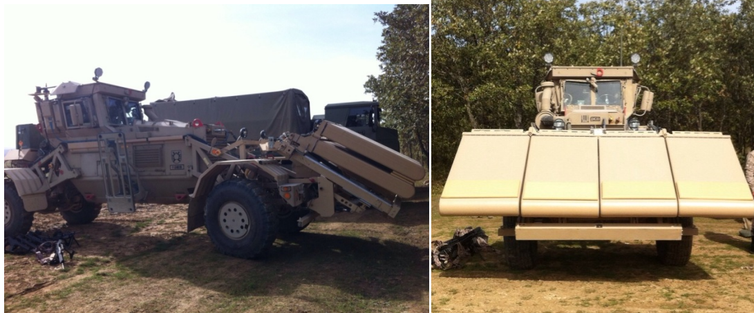
Ilustración 18. VMMD (Vehicle Mounted Mine Detector ó Vehículo de Caballería de Detección de Minas).
