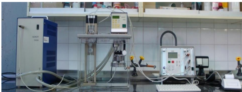
Figura 140. Viscosímetro capilar modelo ViscoSystem AVS 470
