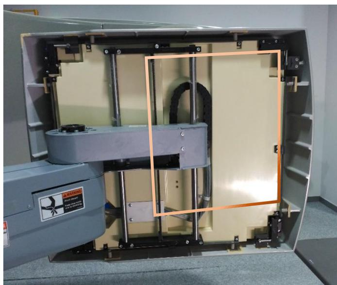
*Figura 6. Fotografía de la parte posterior del EPID, con la proyección del tamaño máximo del campo de radiación.*
