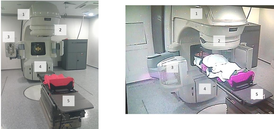
Figura 26. Acelerador lineal de electrones utilizado para tratamientos de radioterapia. 1, gantry. 2, cabezal. 3, tubo de rayos X. 4, EPID. 5, mesa de tratamiento o camilla.
