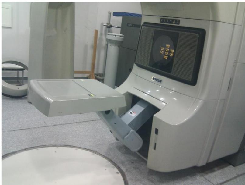
*Figura 1. Fotografía de un acelerador lineal de electrones utilizado para tratamientos de radioterapia en la que se muestra el EPID desplegado.*
