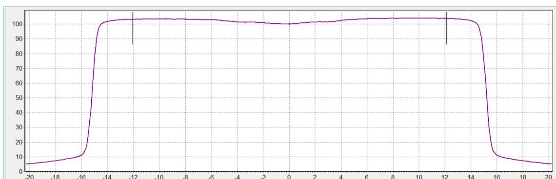
Figura 31. El mismo perfil de la Figura 30, pero a profundidad  $d_{max}$ . Se señala, mediante dos barras verticales, la presencia de dos protuberancias, denominadas “cuernos”.
