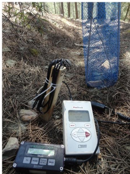
Figura 10: Fotografía del dispositivo manual ProCheck (Decagon Devices ®) registrando los datos de humedad de 30-40 cm y de 0 a 20 cm de profundidad y TDR 100 (Spectrum Technologies ®), respectivamente. Fuente: fotografía realizada durante las campañas de muestreo.
