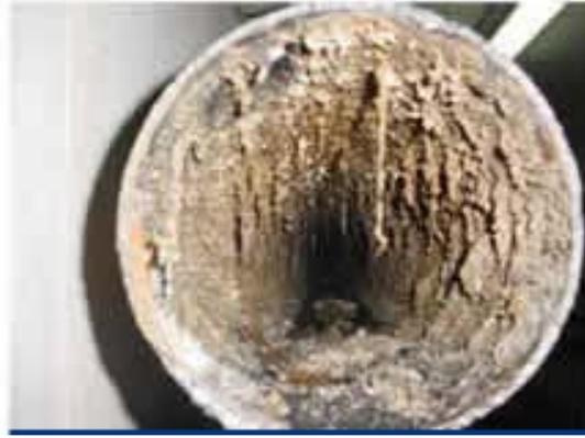
**Figura 6.** Incrustaciones de estruvita en la línea de fangos de la EDAR Murcia-Este (Tomada de Pastor, 2008)
