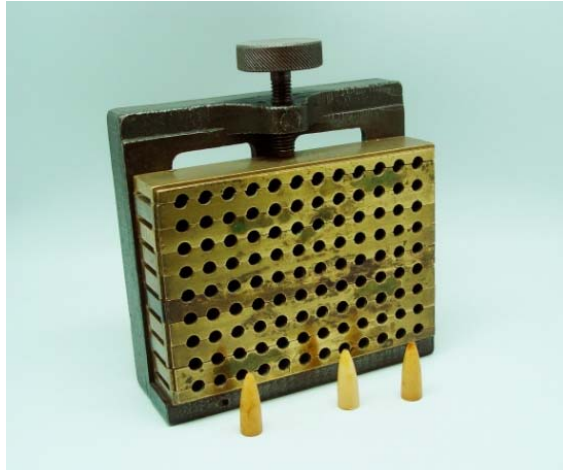
Figura 369: Molde para 108 supositorios (utilizados para la elaboración de supositorios de glicerina)
