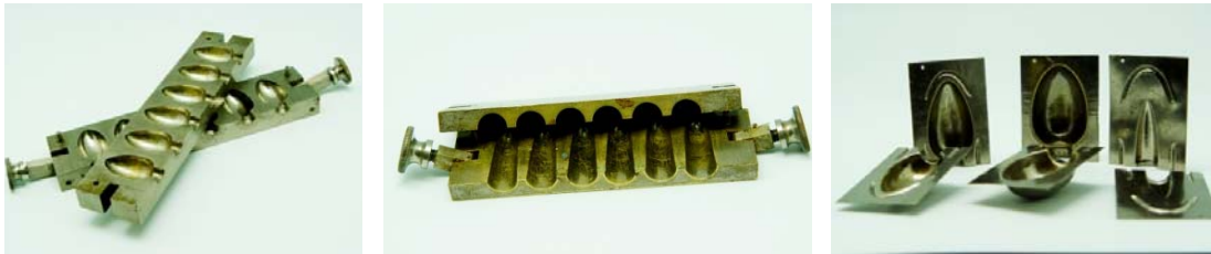
Figura 370: Moldes de acero inoxidable para la elaboración de óvulos y supositorios
