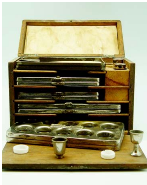
Figura 373: Capsulador de Mostard con dosificadores, juego completo
