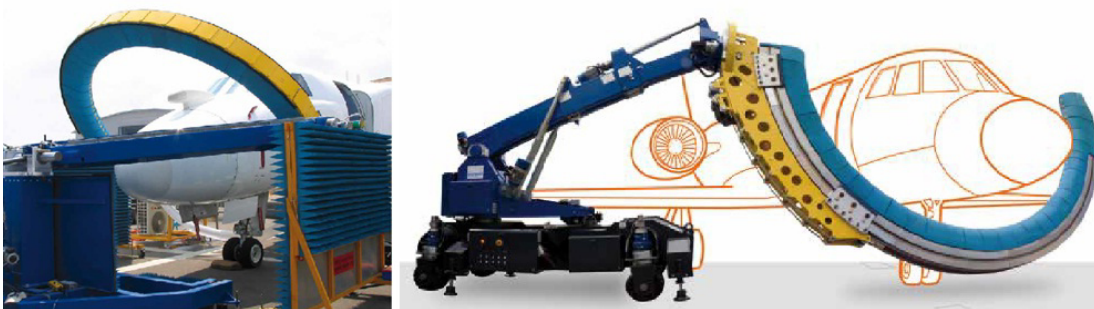
Figura 2.20: Sistemas especiales multisonda - SATIMO (obtenida de [101])
