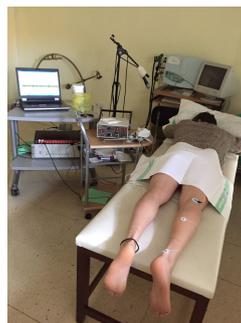
Imagen durante uno de los experimentos con el sujeto colocado en decúbito prono y se pueden observar tanto el electromiógrafo con el registro de la actividad.
