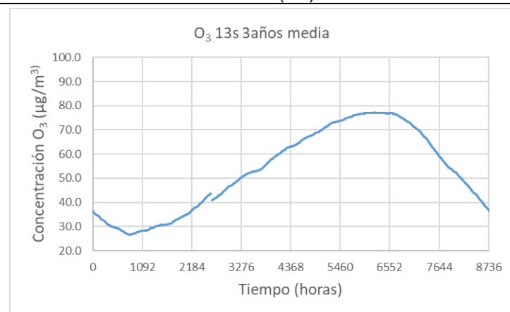
Figura 4.3. Niveles de concentración de ozono a lo largo del año en la estación El Pardo (SUB).
