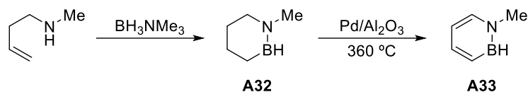
Esquema 2.8. Síntesis del primer 1,2-azaborino monocíclico con un enlace B–H.
