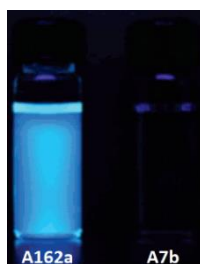
Figura 2.15. Fluorescencia del BN-fenantreno A162a (izquierda) y A7b (derecha) por irradiación a 365 nm.
