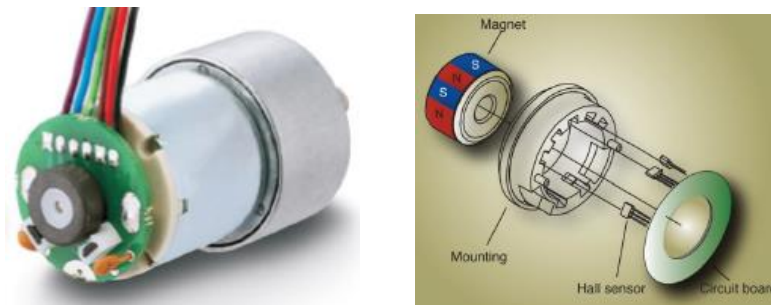
Figura 16. Encoder magnético acoplado al eje del motor DC
