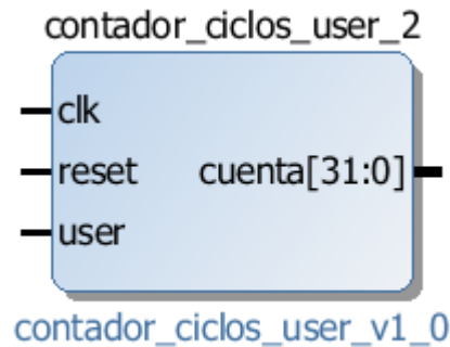
Figura 3.30: Bloque VHDL contador de ciclos de reloj entre dos flancos de la señal user
