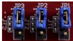
Figura 3.28: Configuración jumpers para el uso de un dispositivo JTAG
