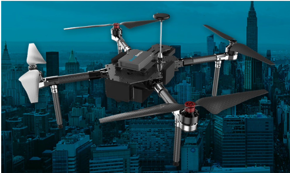
Figura 3.2: Dron cuadricoptero controlado por OcPoC
