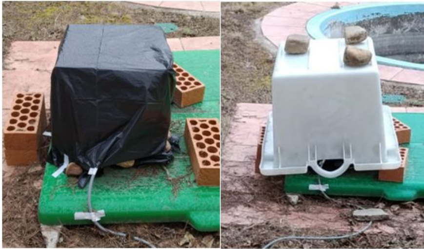
Imagen 31 -Caja contenedora del sensor en la situación 1
