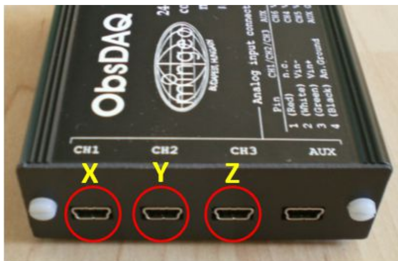
Imagen 24 - Entrada de los canales de los canales de 24b de ObsDAQ donde se conectan las salidas del magnetómetro
