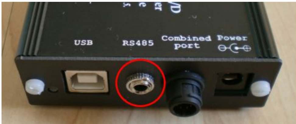
Imagen 26 – Puerto RS485 del módulo ObsDaq
