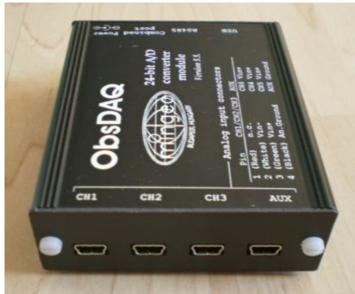
Imagen 16 – Aspecto del módulo de adquisición de datos ObsDAQ 5.6 de MinGeo.
