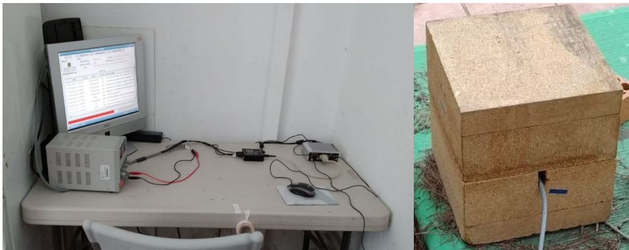
Imagen 30 – A la izquierda quipo en el interior de la caseta: MAGREC-4B, Módulo ObsDag y fuentes de alimentación. A la derecha caja de corcho donde se sitúa el sensor y la base móvil.
