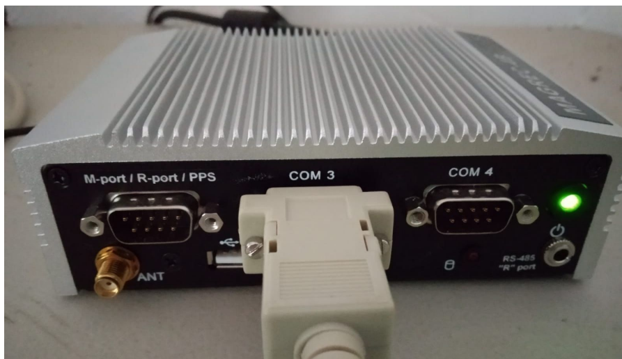
Imagen 27 – Puerto de conexión RS485 (COM 3) del MAGREC-4B
