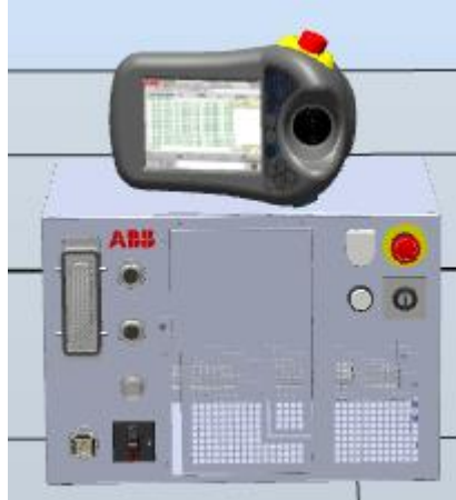
Figura 4. 16 Controlador y FlexPendant robot
