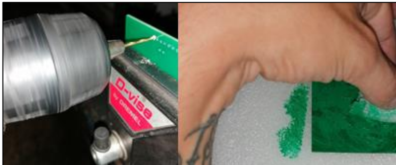
Figura 22: Procesos de rematado para las PCB
