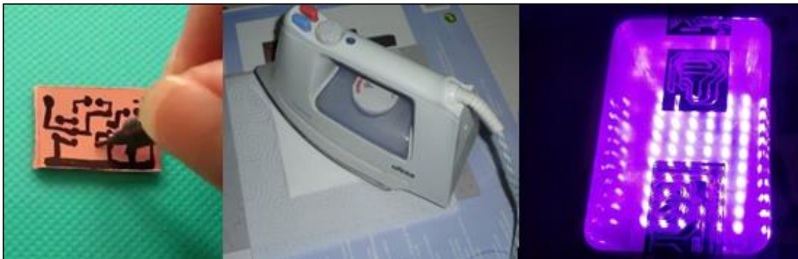
Figura 19: Métodos para el grabado de las pistas en una PCB
