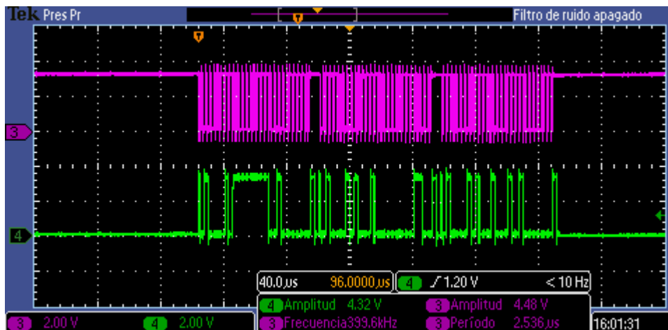
Figura 95: Captura del osciloscopio de la configuración del sensor de imagen
