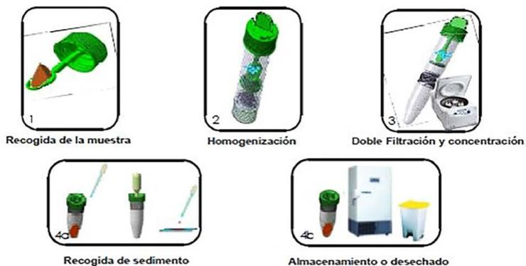
Figura 2. Protocolo Total-Fix MiniSystem Real. Fuente: Durviz.
