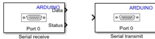
Figura 69. Bloques de comunicación Bluetooth con hardware Arduino
