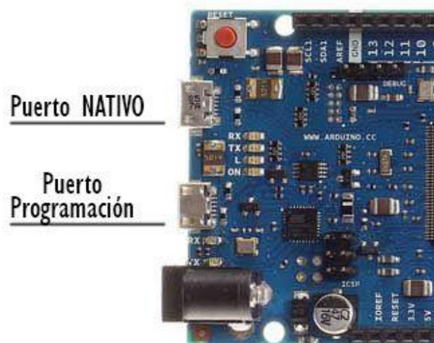
Figura 4. Puertos USB de la Arduino Due
