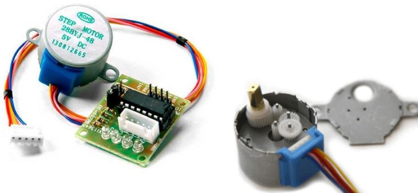
Figura 19. Motor 28BYJ-48 y PCB con driver ULN2003 integrado
