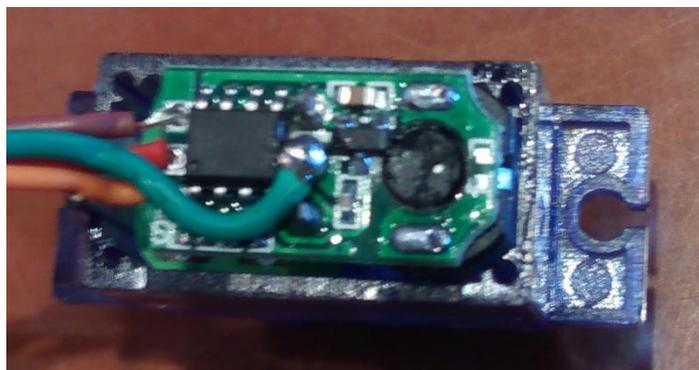
Figura 54. Salida analógica del potenciómetro del servo
