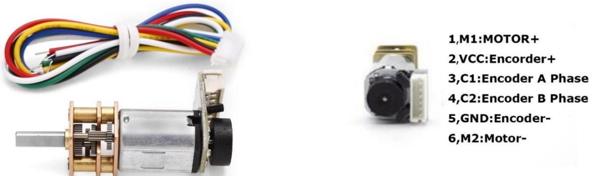
Figura 8. Motor GA12-N20 y terminales
