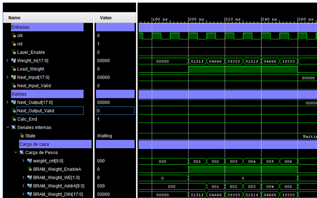
Figura 43. Carga de pesos del bloque Capa.
