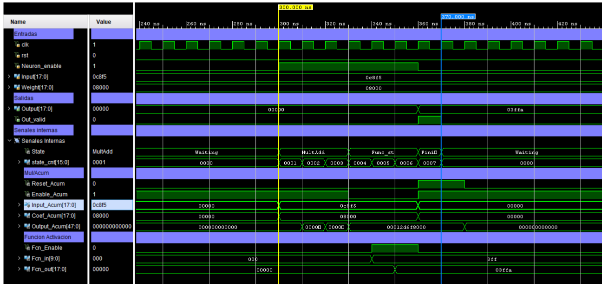
Figura 38. Saturación positiva del bloque Neurona.
