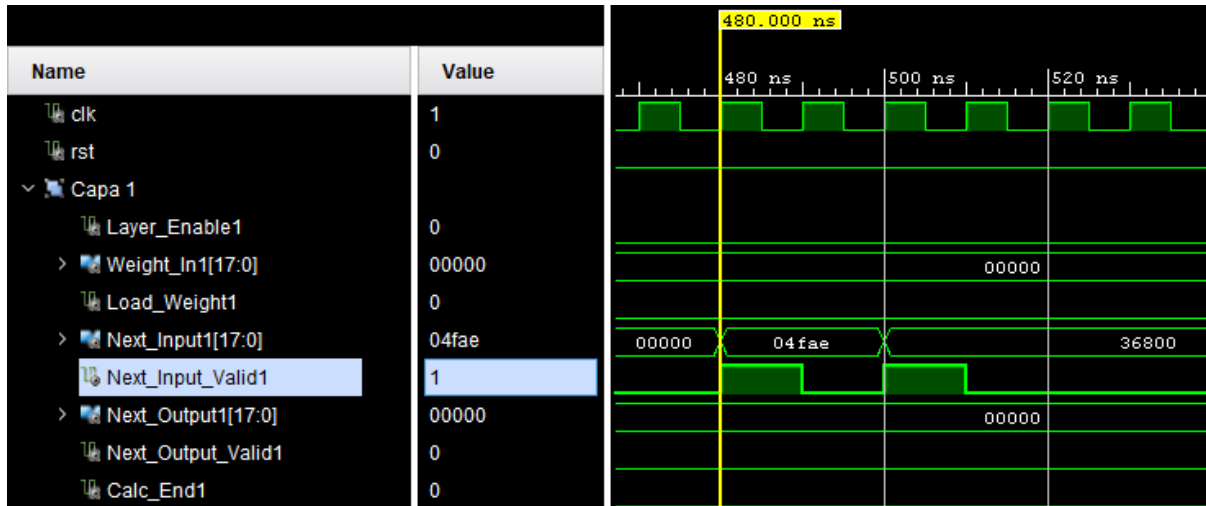
Figura 47. Carga de entradas de la red neuronal bicapa
