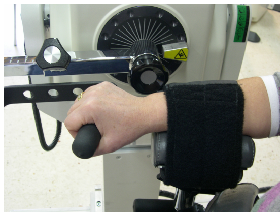
Figura 6. Estabilización mediante correas y alineación del eje de la muñeca con el eje del dinamómetro tomando como referencia ósea la apófisis estiloides cubital(imagen extraída de Bosch Martín MA y Spottorno Rubio MP. Valoración de la fuerza isocinética 76 ).
