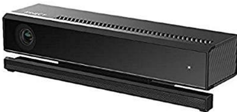
Figura 38. Cámara Kinect 2.0 utilizada para registro de la pose del robot
