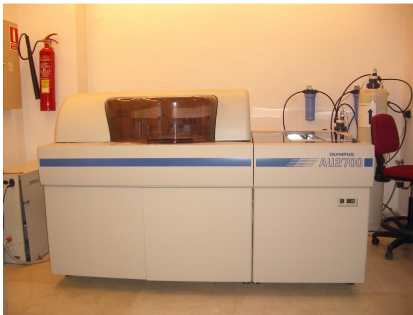
Imagen 1: Auto analizador Olympus AU 2700
