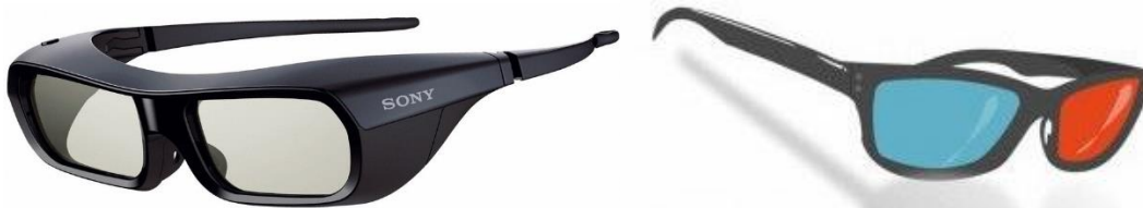
Figura 1.5. Diferencia entre gafas activa (izquierda) y pasivas (derecha).
