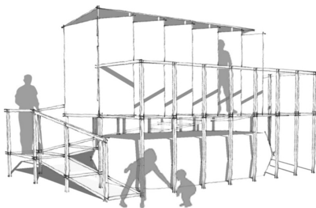
Figura 1. Módulo de letrinas elevadas
