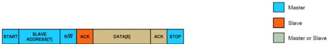
Ilustración 5 Estructura general de comunicación I2C
