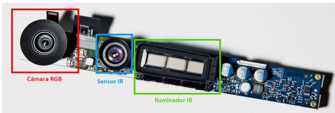
Figura 2.11: Hardware de la KinectII
