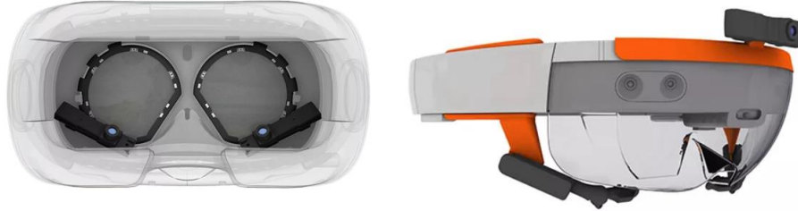
Fig. 6. Add-ons de seguimiento ocular en dispositivos XR de Pupil Labs. A la izquierda, add-on binocular para HTC Vive; a la derecha, add-on binocular para Microsoft HoloLens. Fuente: página oficial de Pupil Labs.
