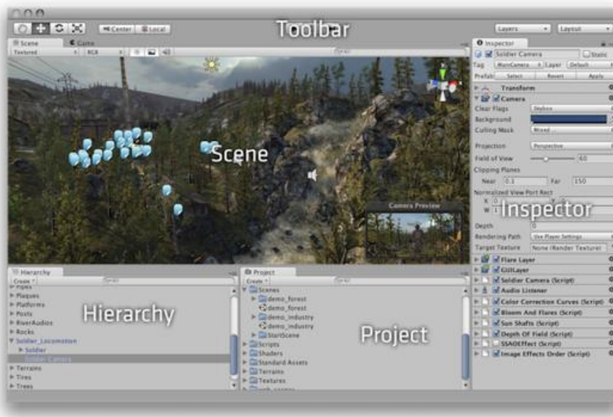
Fig. 9. Interfaz del editor de Unity. Se pueden observar los paneles mencionados: Scene, Hierarchy, Project e Inspector, además de una barra superior marcada como Toolbar. Fuente: Documentación de Unity.
