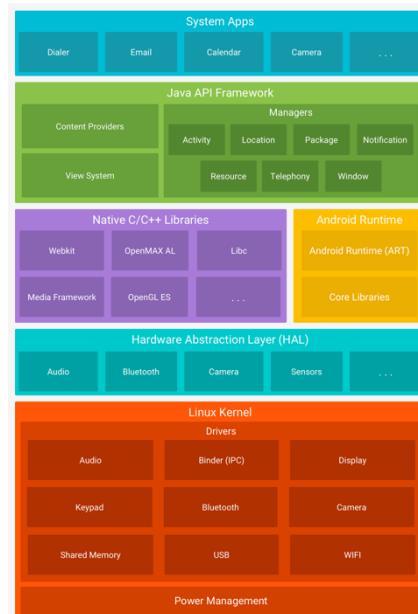
Ilustración 11. Arquitectura de la plataforma Android
