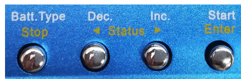
Figura A.3: Botones del cargador LiPo Balance Charger Imax B6AC
