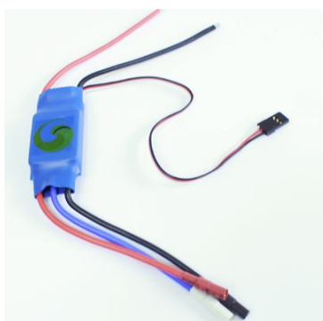
Figura 2.4: Controlador electrónico de velocidad, ESC
