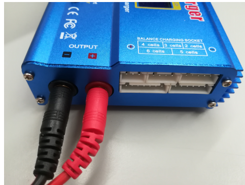
Figura A.2: Puertos de balanceo de celdas
