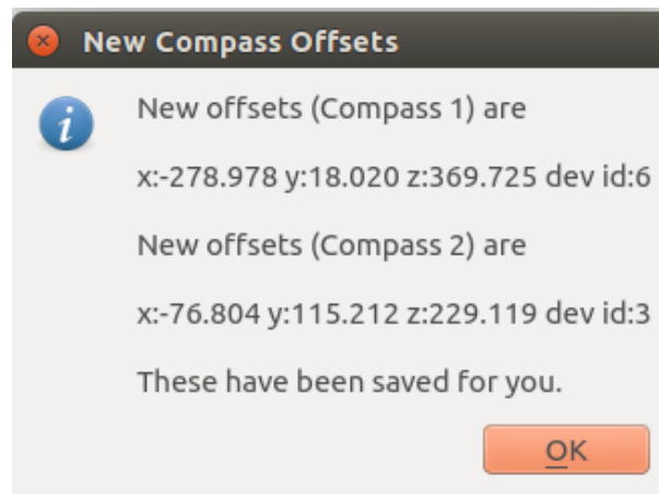
Figura 5.9: Valores de offset de las brújulas, 1 y 2, en sus diferentes ejes
