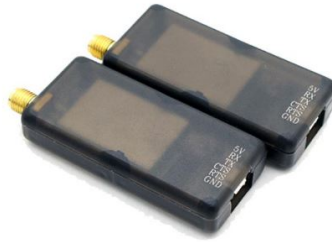
Figura 2.14: Radio de telemetría
