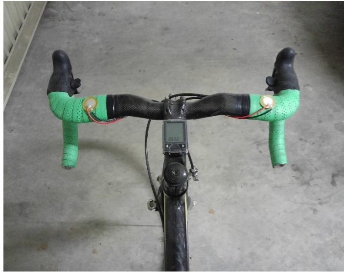
Figura 33. Montaje discos piezoeléctricos manillar.
