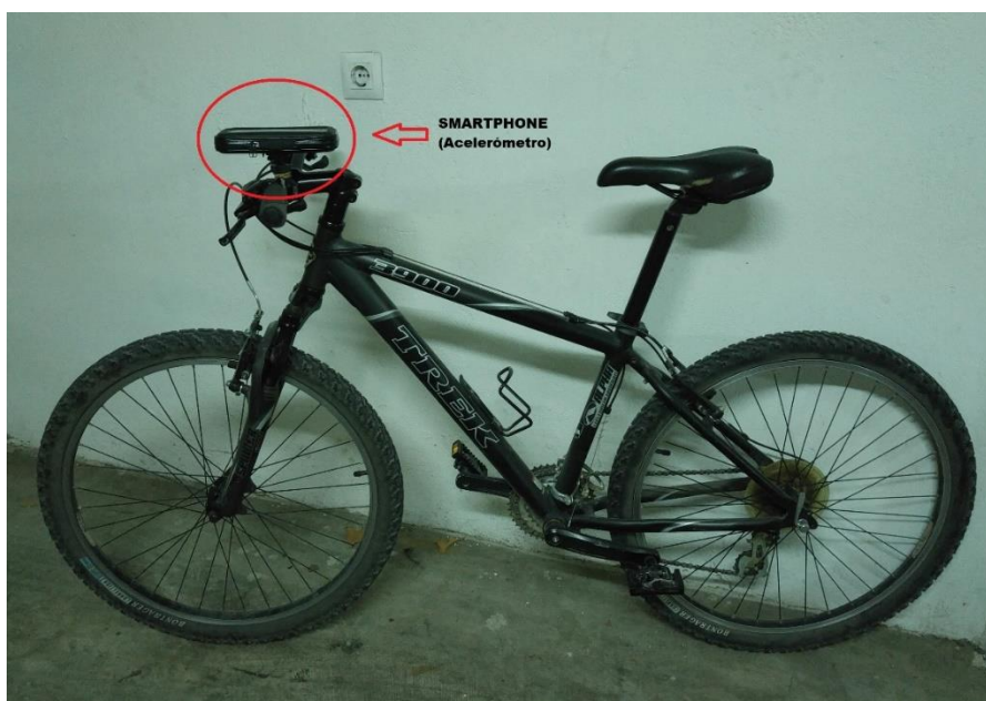
Figura 24. Ubicación Acelerómetro para medir las vibraciones.
