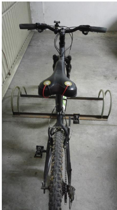
Figura 34. Montaje discos piezoeléctricos sillín.
