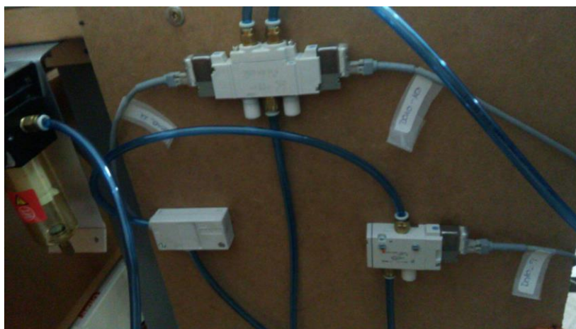
Figura 2.12 Conexionado de aire comprimido y electroválvulas
