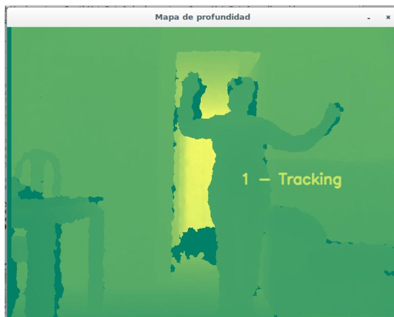
Figura 2.3: Ejemplo de representación de mapa de profundidad en el que se pueden ver zonas oscuras debido a las limitaciones de Kinect.
