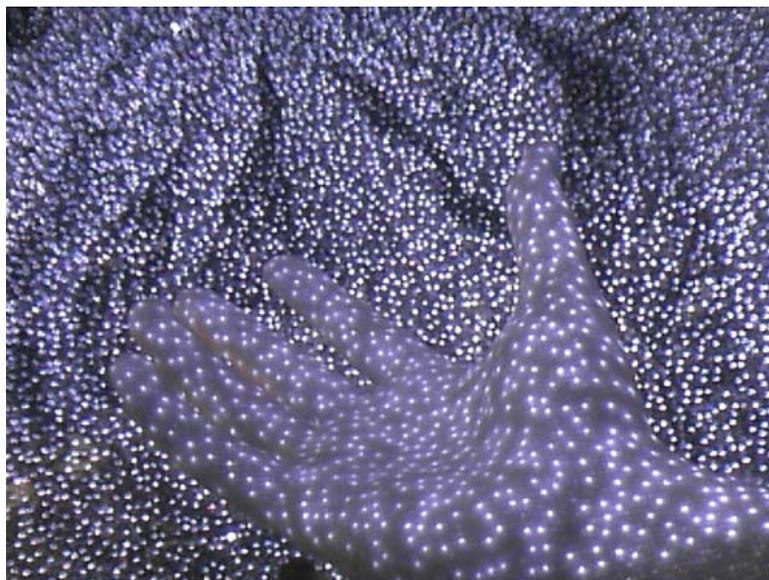
Figura 2.2: Patrón de luz infrarroja emitido por Kinect y proyectado sobre una mano.
