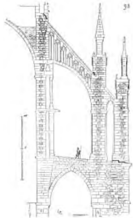
Imagen 478. Sección constructiva de la catedral de Amiens. Viollet-Le-Duc, E. (1996)
