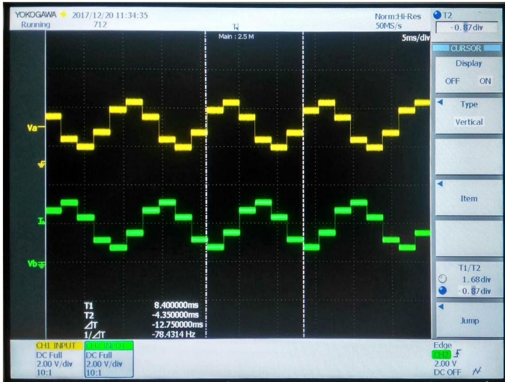
Imagen 6.71: Señales Va y Vb. Parámetros: M_a=0.625 , M_f=6 , F_1=80
