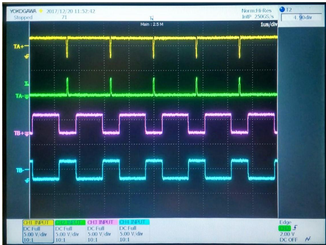
Imagen 6.72: Señales de control TA+, TB+. Parámetros: M_a=1 , F_1=100 , M_f=5760
