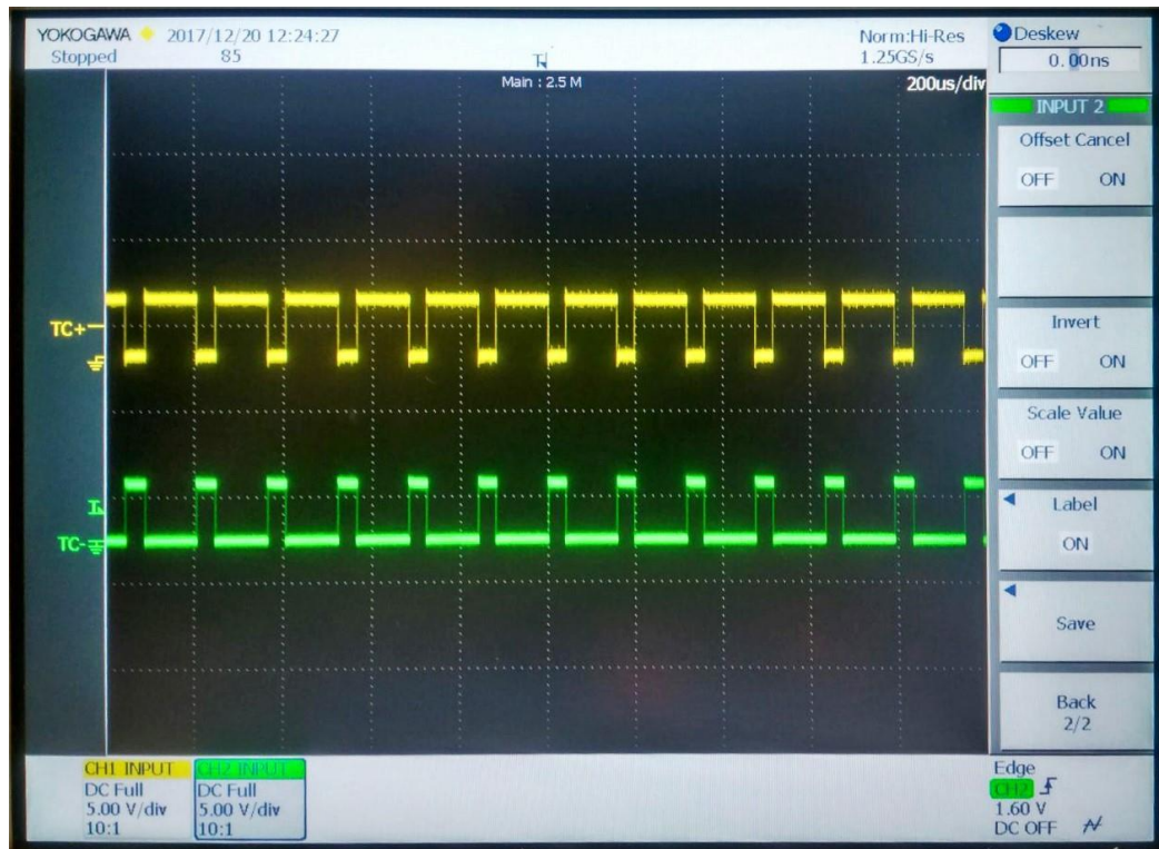
Imagen 6.73: Señales de control TC+, TC-. Parámetros: M_a=0.5 , M_f=90 , F_1=70
