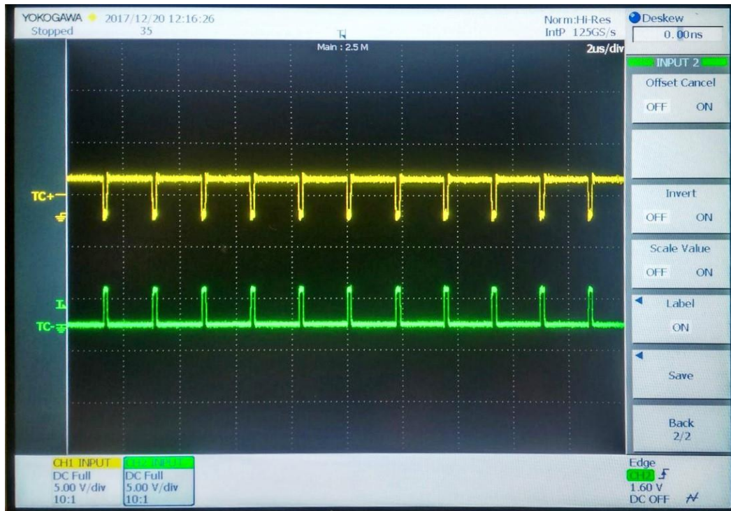
Imagen 6.71: Señal de control TC+. Parámetros: M_a=1 , M_f=5760 , F_1=100
