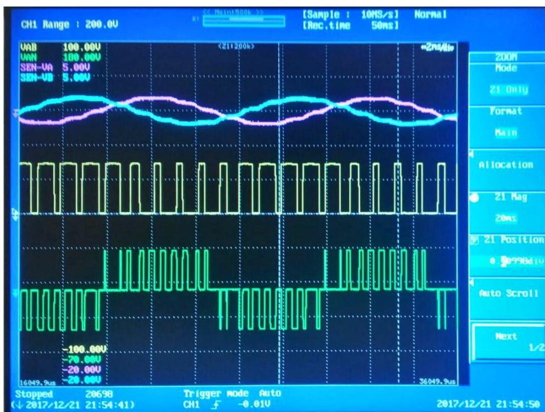
Imagen 6.76: Práctica real. Parámetros: M_a=0.5 , M_f=20 , F_1=100\text{Hz}
