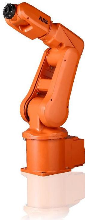
*Ilustración 2-5: Brazo robótico IRB120*
