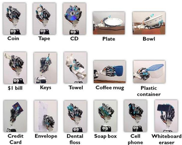
Ilustración 1-3: Distintas posiciones de la mano robótica de la universidad de Washington
