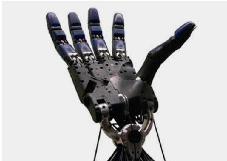
*Ilustración 1-1: Mano robótica Shadow Dexterous*
