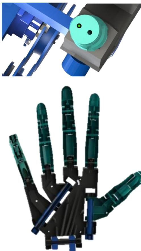
*Ilustración 2-43: Guiado de cables a través de la mano*
