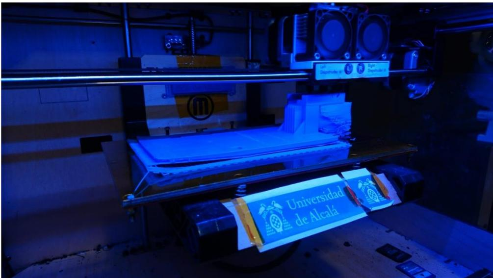
Ilustración 2-33: Impresora 3D imprimiendo piezas
