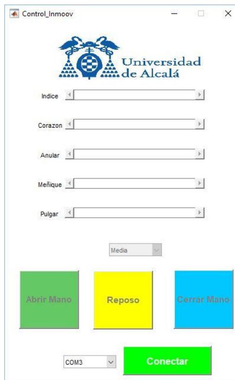
*Ilustración 4-4: Interfaz de control de la mano robótica*
