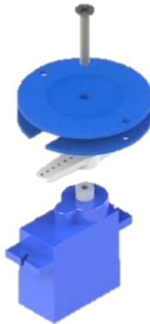
*Ilustración 2-11: Ensamblaje de motor y "Agarre motor"*
