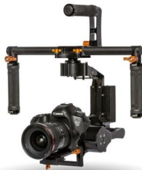
Figura IV.2 Sistema de estabilización manual (steadycam) con sistema de control.
