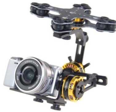
Figura IV.3 Gimbal 3 axis con motores Brushless.
