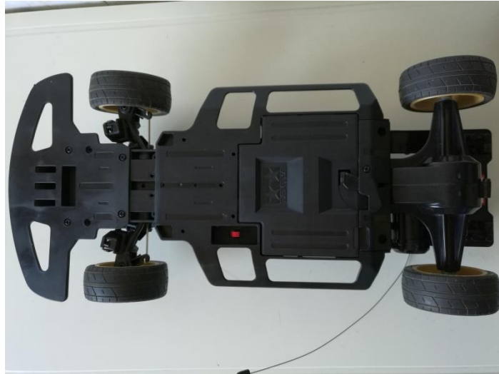
Figura 2. 7: Alojamiento alimentación e interruptor
