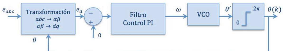
Figura 22 Diagrama de bloques de PLL
