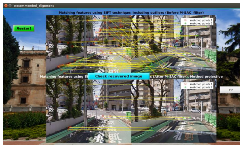
Figura 6.9: Buen resultado tras filtro RANSAC+paralelo
