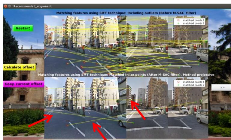
Figura 6.10: Mal resultado tras filtro RANSAC+paralelo
