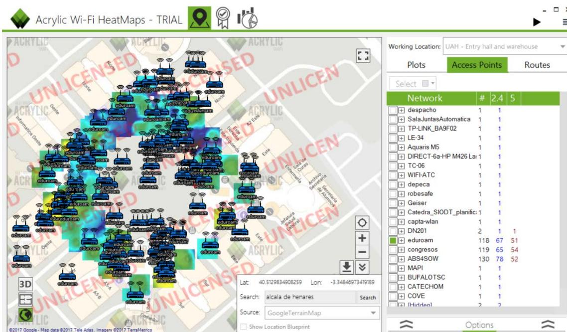
Figura 6: Análisis espectral 2.4GHz y 5GHz
