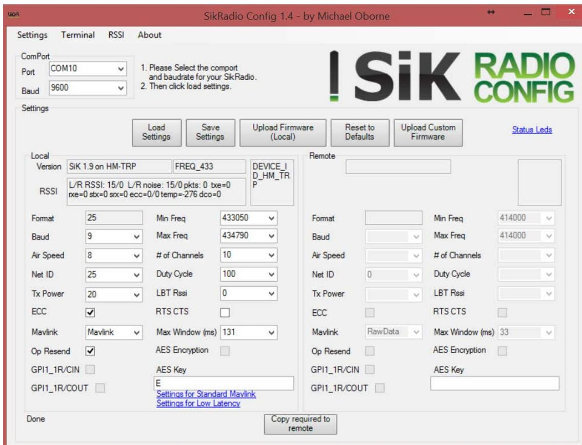
Figura 29: Configuración 3dr radio
