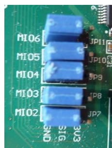
Figura 8.9: Colocación de jumpers en aplicación bare-metal
