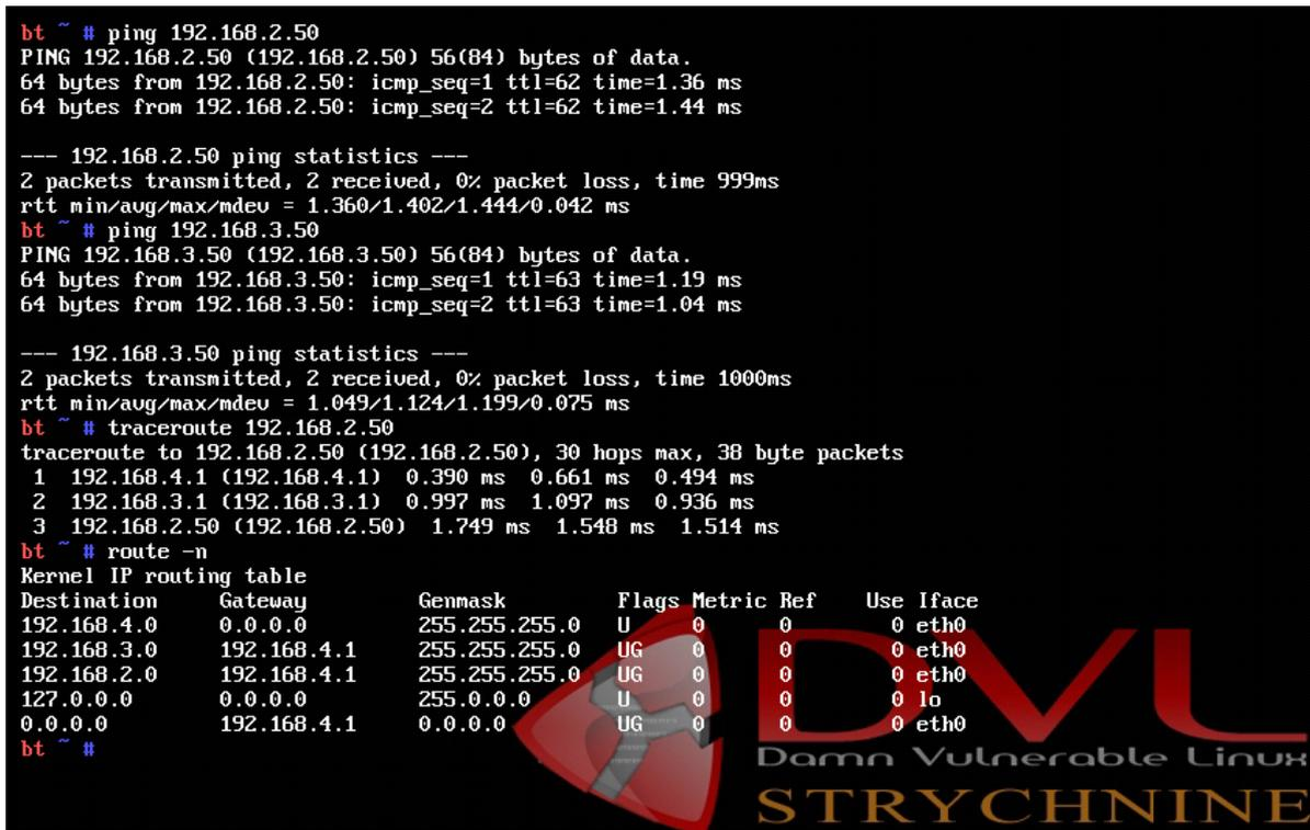
Ilustración 99: Pruebas de conectividad desde host situado en el segmento 3.
