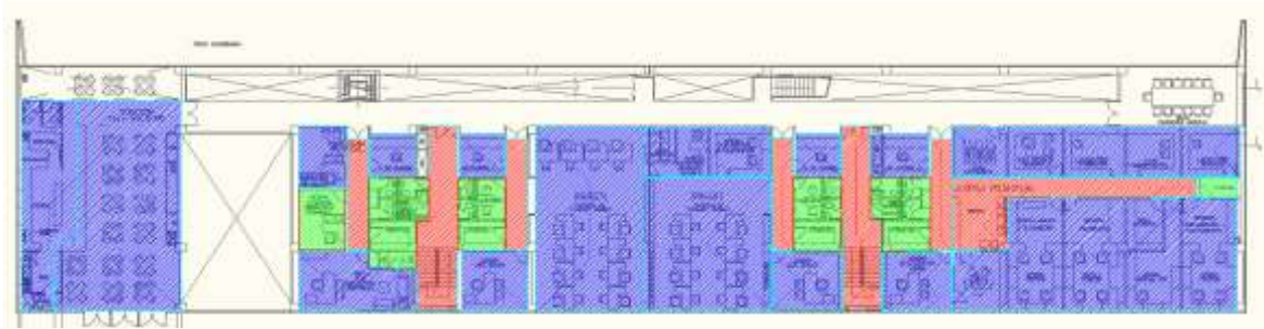
Figura 50 Distribución de los tipos de control en un edificio administrativo
