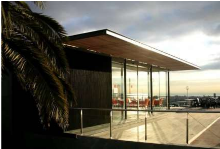
Figura 34 Voladizo para protección solar de superficies vidriadas
