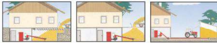
Figura 42 Diferentes tipos de almacenamiento de biomasa para su uso en calderas
